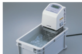
④精製水を温める (恒温水槽/ウォーターバス)
